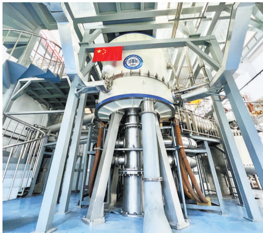
图为稳态强磁场实验装置混合磁体。
