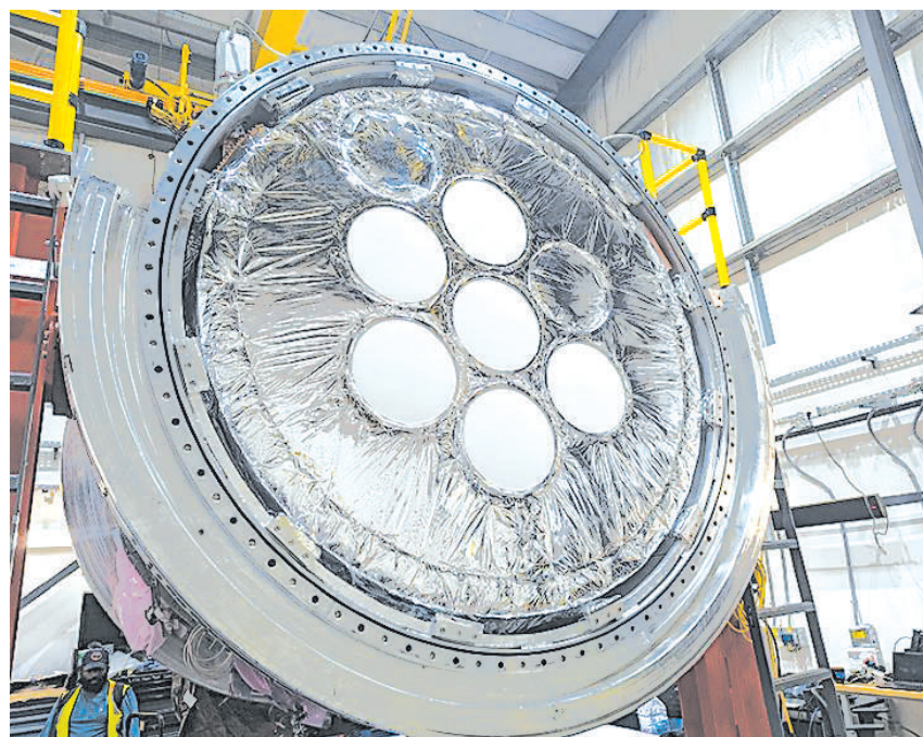
图为西蒙斯天文台大口径望远镜接收器的正面,该天文台是迄今建造的用于观测宇宙微波背景的最大设施。
