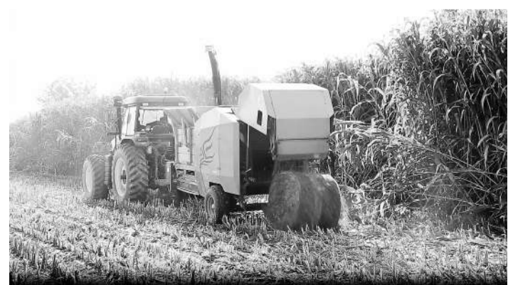
青贮饲料联合打捆机在甘肃武威黄羊镇进行饲用甜高粱的收获打捆作业。受访者供图
