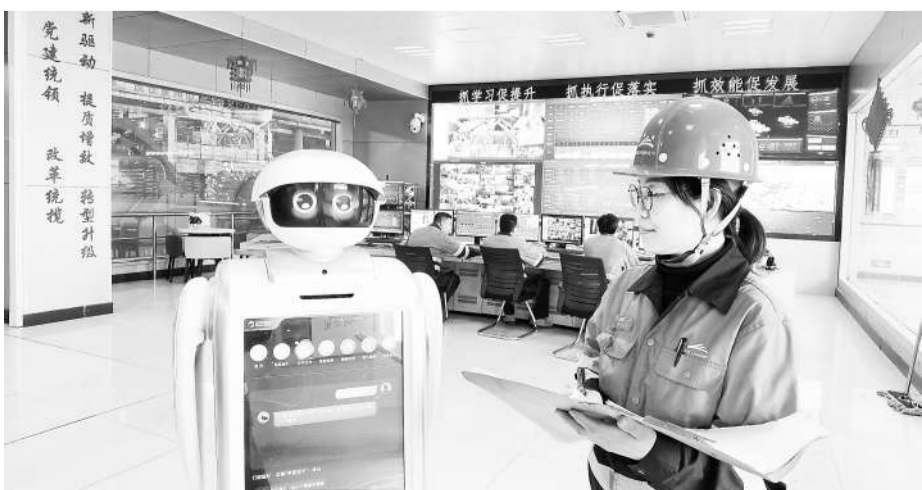
岗位职工向智能巡检机器人下达指令。 金川集团新闻中心供图
