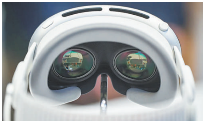
苹果Vision Pro拥有8个外部摄像头和4个跟踪眼球运动的内部摄像头。 本文图片来源:《自然》网站
