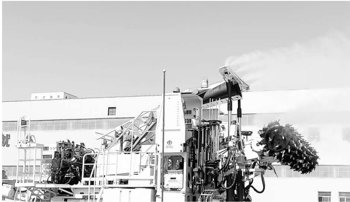
图为钻锚一体化智能快速掘进成套装备。
