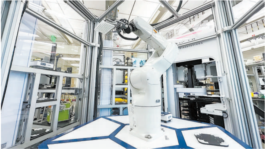
技术的飞跃支持人工智能引导的药物设计,如可以纯化蛋白质和移动液体的全机器人工作站。 图片来源:英国《自然》网站
