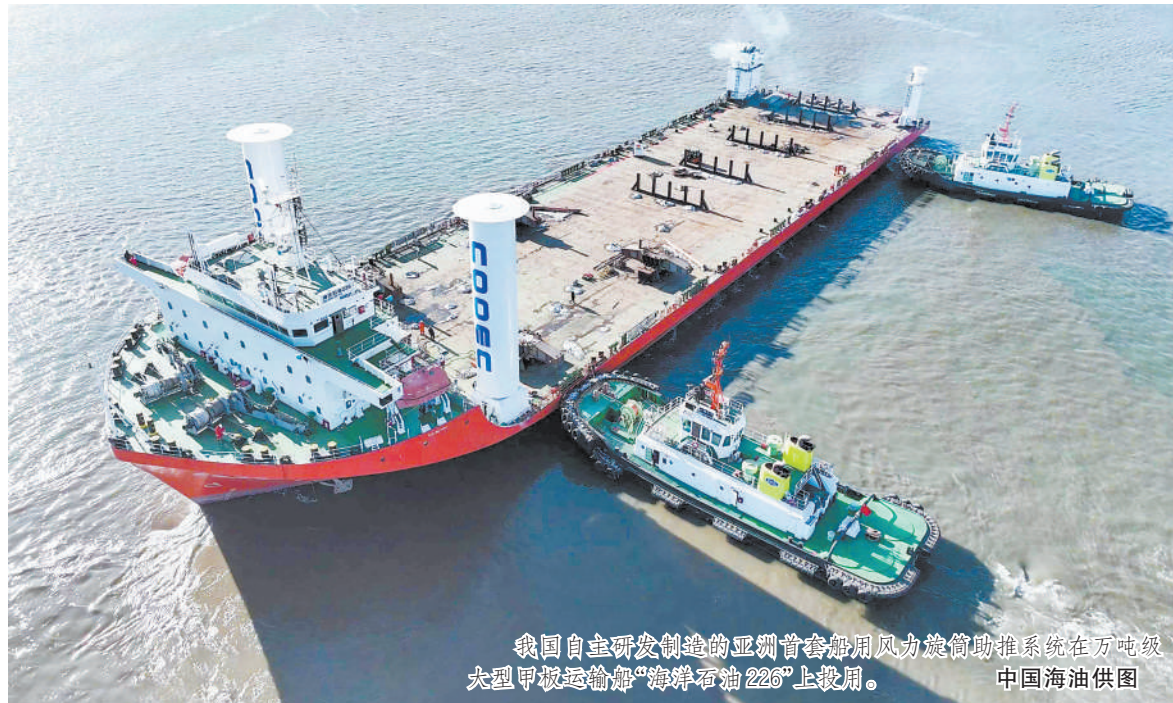
我国自主研发制造的亚洲首套船用风力旋筒助推系统在万吨级大型甲板运输船“海洋石油226”上投用。中国海油供图
