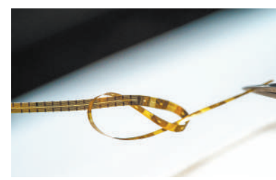
超薄、灵活且可定制的探针由临床级材料制成。 图片来源：加州大学圣迭戈分校
