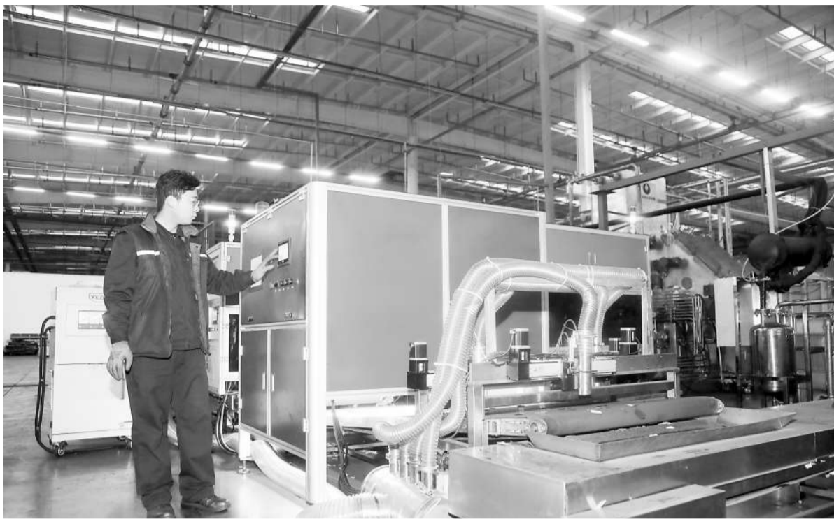
在天津滨海高新区，天津赛德美公司锂离子电池精细化拆解生产线上，员工正在操作自动识别分拣系统。
