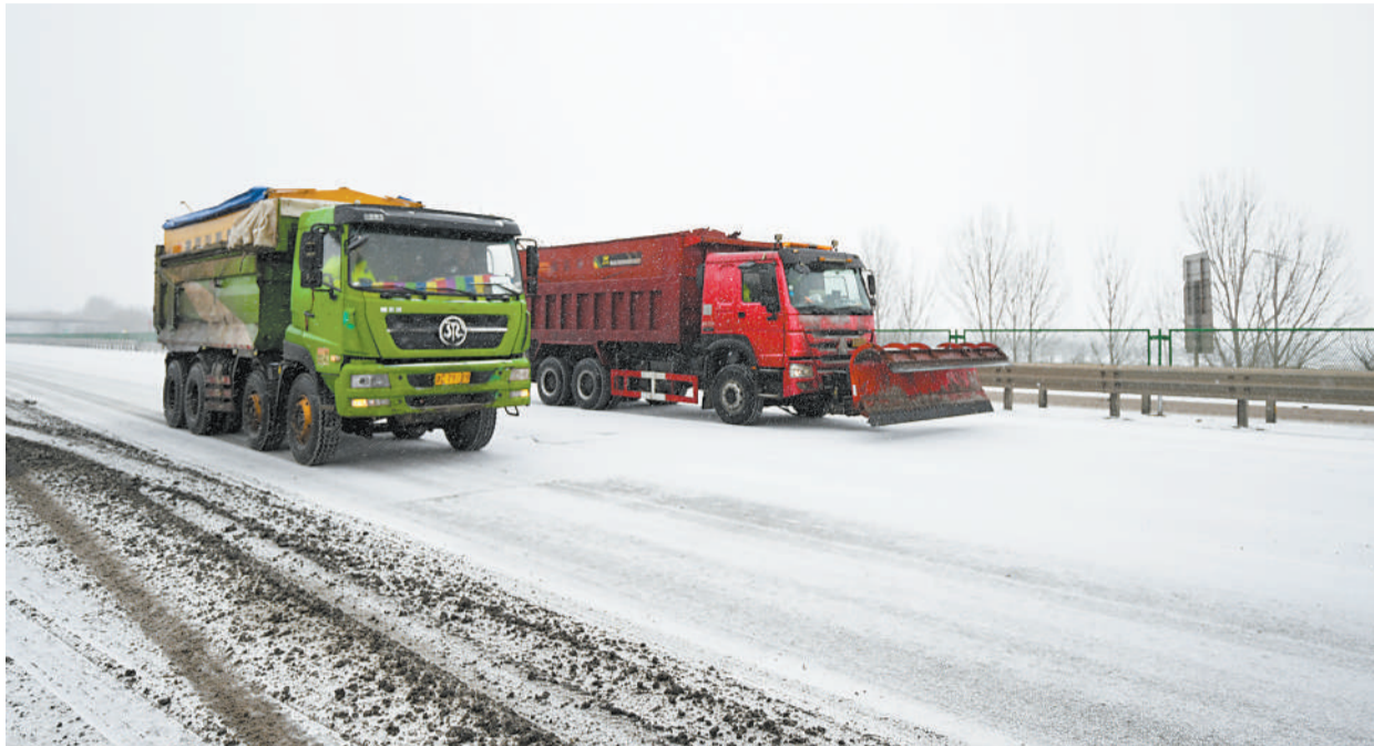
在长深高速天津段,清融雪车辆在路面作业。
