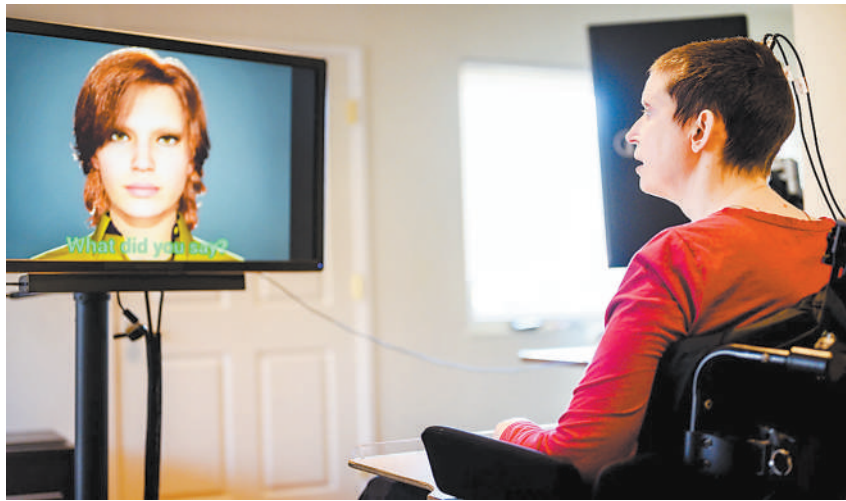
安使用脑机接口将大脑信号转化为虚拟人物的语言和动作。图片来源：《自然》网站
