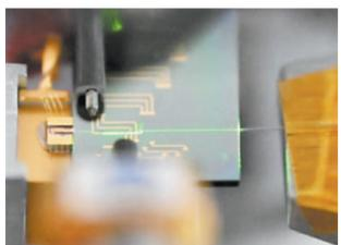
基于纳米光子硅酸锂的芯片级超快锁模激光器。
