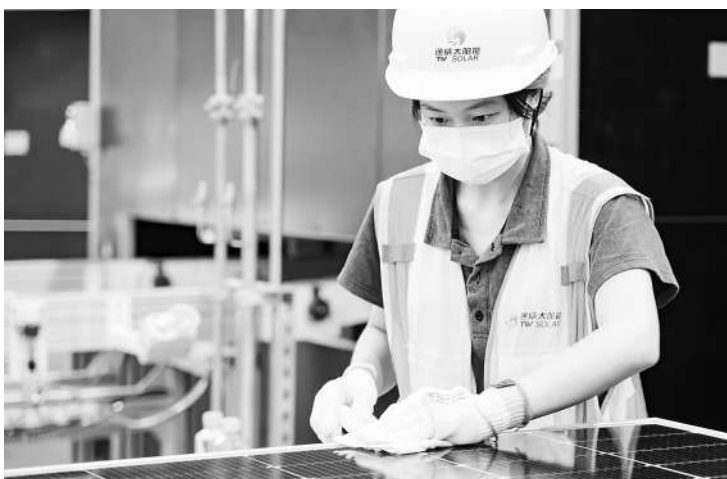
图为通威太阳能(组件)金堂基地员工对组件进行正面清洗。受访者供图
