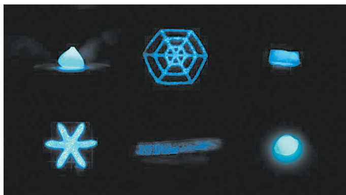
柔软的活性材料会因机械应力（压缩、拉伸或扭曲）而发光。 图片来源：加州大学圣迭戈分校工程学院
