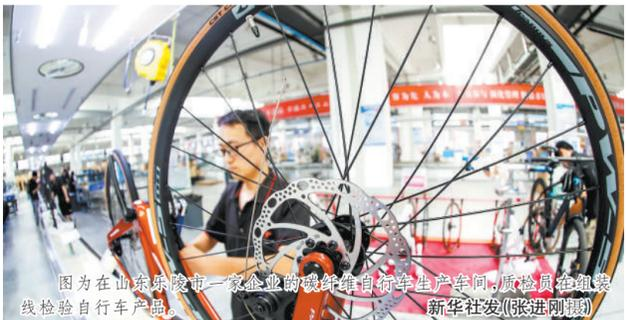
图为在山东临沂市一家企业的碳纤维自行车生产车间,质检员在组装线检验自行车产品。新华社记者(张进刚)摄
