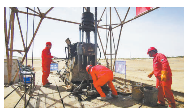
塔克拉玛干沙漠里，科研人员操作大型环境钻机钻取岩芯。谢震霖摄
