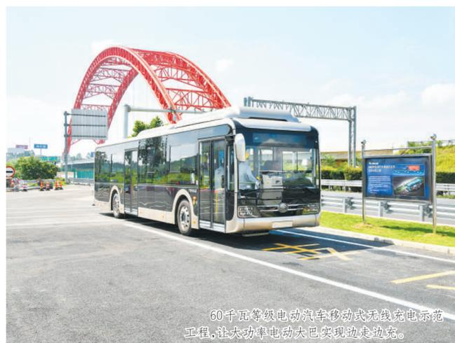
60千瓦等级电动汽车移动式无线充电示范工程，让大功率电动大巴实现边走边充。
