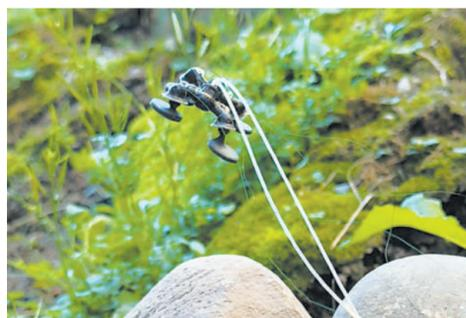
甲烷和氧气流被注入机器人的每只脚中,气体之间发生化学反应,并以微爆炸的形式释放能量,使机器人跳跃或爬行。
