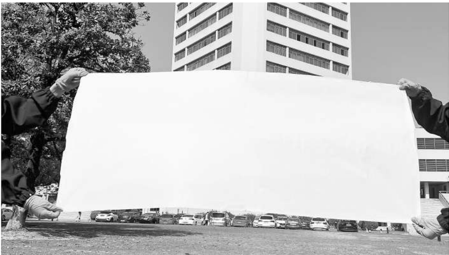
由疏水性纳米纤维膜和亲水性纳米纤维膜组成的纳米织物。
