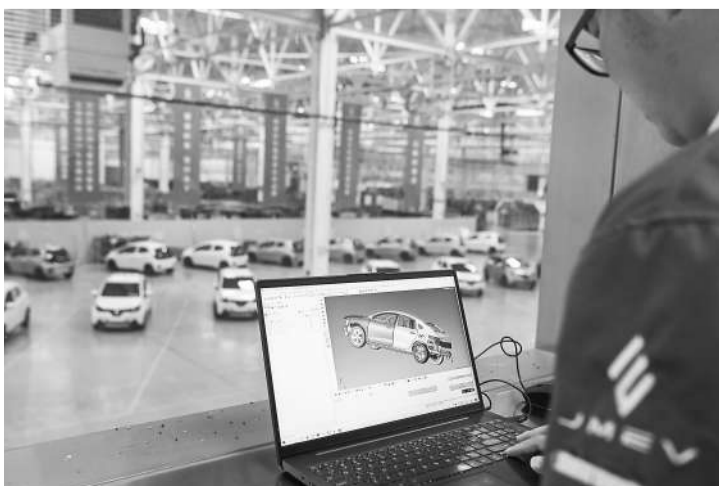
图为江铃集团新能源汽车有限公司工程研究院内，碰撞安全工程师曾祥雷正在用工业设计软件建模，进行碰撞仿真优化设计。
