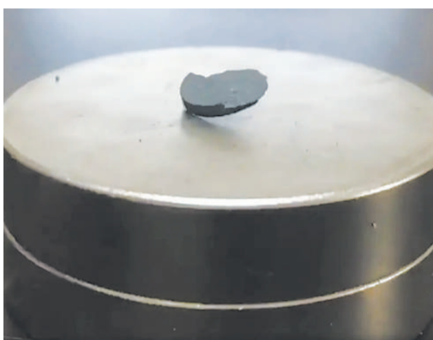
在视频演示中,LK-99圆盘的一个边缘上升,但另一边缘似乎与磁铁保持接触。 图片来源:LK-99研究团队金贤德等人
