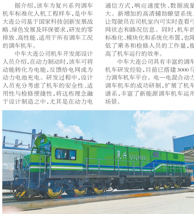
中国中车集团大连公司研制的电—电混合动力调车机车。受访单位供图
