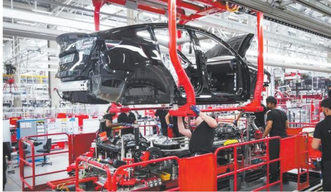
柏林的超级工厂在对特斯拉Model Y进行总装。图片来源:特斯拉官网
