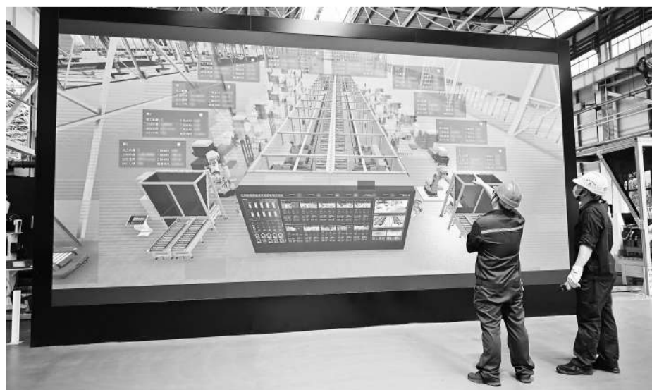
三一重工股份有限公司18号工厂依托根云工业互联网操作系统实现生产全要素透明化。受访单位供图
