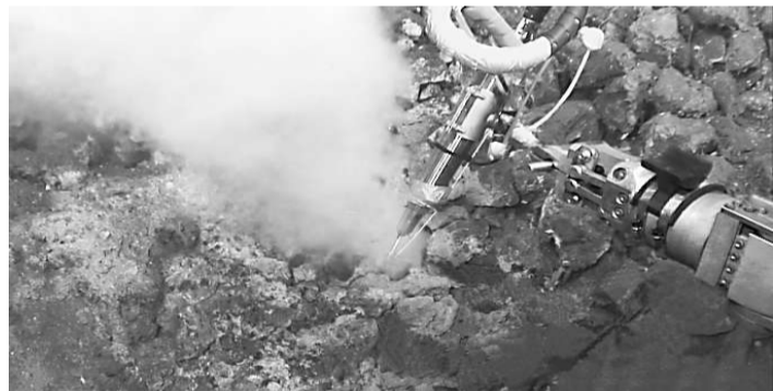
“发现”号水下缆控潜器开展激光拉曼综合原位探测。 中国科学院海洋所供图
