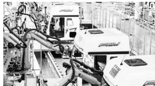
近年来,中国一汽从创新端入手,以科技赋能,着力提升生产效率,一批高智能化、高自动化的新型工厂顺利投产。在智能化的生产车间内,无数智能机器人有条不紊地按照行程轨迹进行工作,冲压、焊装、涂装、总装……各生产工序中都有智能机器人的身影。图为位于吉林长春的一汽解放J7智能工厂内,智能机器人进行车辆玻璃装配及涂胶工作。
