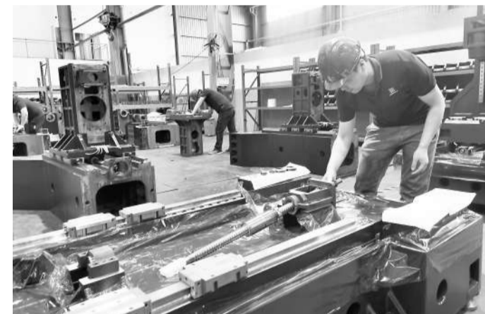
昆山台功精密机械有限公司精密丝杆组装现场。冯登宁摄
