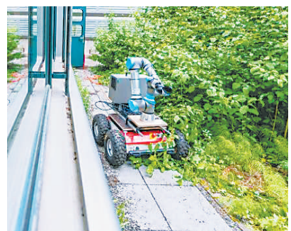
研究人员利用ChatGPT设计的番茄采摘机器人在测试环境中移动。
