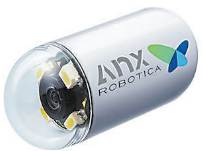
AnX Robotica公司的胶囊内窥镜系统NaviCam。
