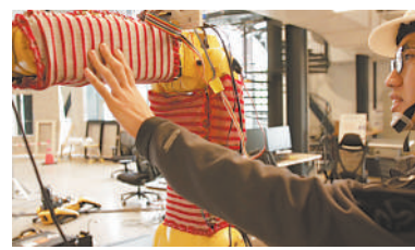
“机器人毛衣”是一种可感知接触和压力的机织纺织品“皮肤”。
