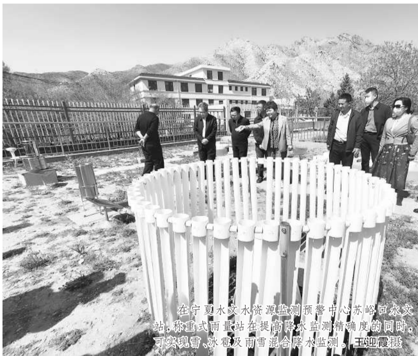
在宁夏水文水资源监测预警中心苏峪口水文站，称道式雨量站，在提高降水监测精度的同时，可实现雪、冰雹及雨雪混合降水监测。王迎霞摄
