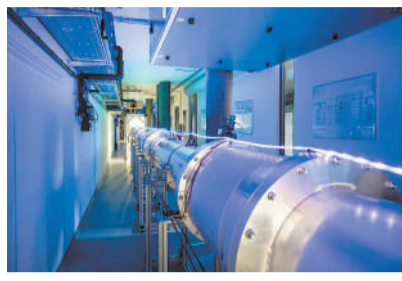
两个超导电路之间30米长的量子连接的一部分。
