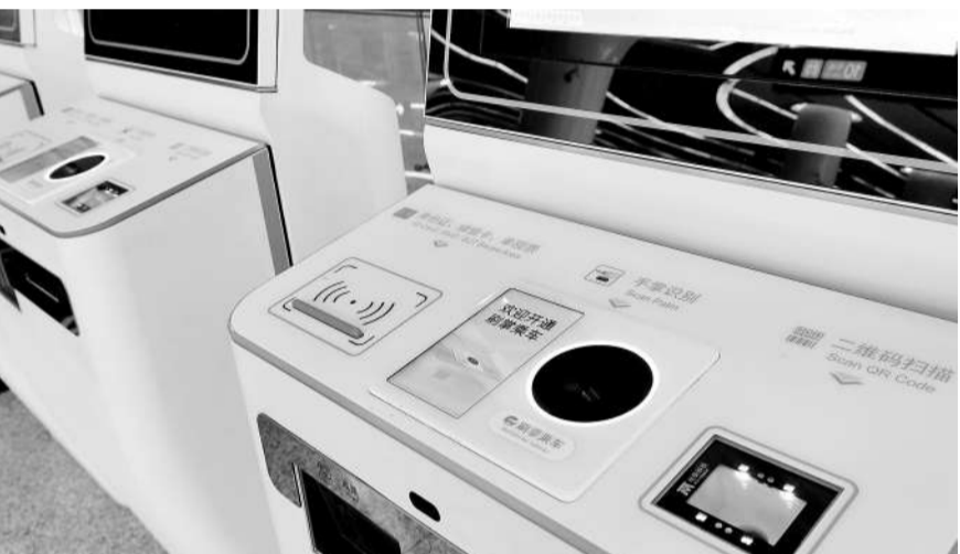
5月10日，三台新型自动售票机亮相北京大兴机场线地铁站，在此机器上，乘客可以“刷掌”乘车。和人脸识别、指纹识别一样，“刷掌”同样属于生物识别技术的一种。乘客只需在小程序中完成授权，开通刷掌支付，将掌心面对圆环内的识别区，即可轻松实现刷掌乘车。左图 乘客在地铁站进行刷掌购票。右图 支持手掌识别功能的自动售票机。
