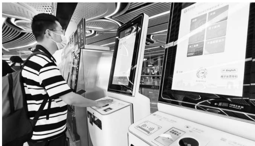
5月10日，三台新型自动售票机亮相北京大兴机场线地铁站，在此机器上，乘客可以“刷掌”乘车。和人脸识别、指纹识别一样，“刷掌”同样属于生物识别技术的一种。乘客只需在小程序中完成授权，开通刷掌支付，将掌心面对圆环内的识别区，即可轻松实现刷掌乘车。左图 乘客在地铁站进行刷掌购票。右图 支持手掌识别功能的自动售票机。
