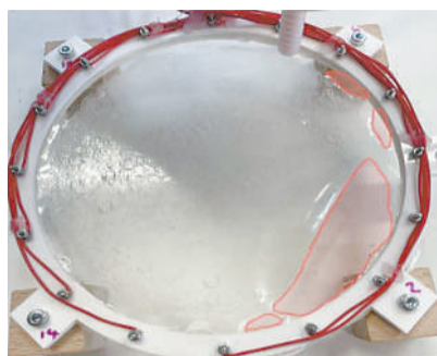
新型水凝胶皮肤在进行损伤检测实验。图片来源:物理学家组织网
