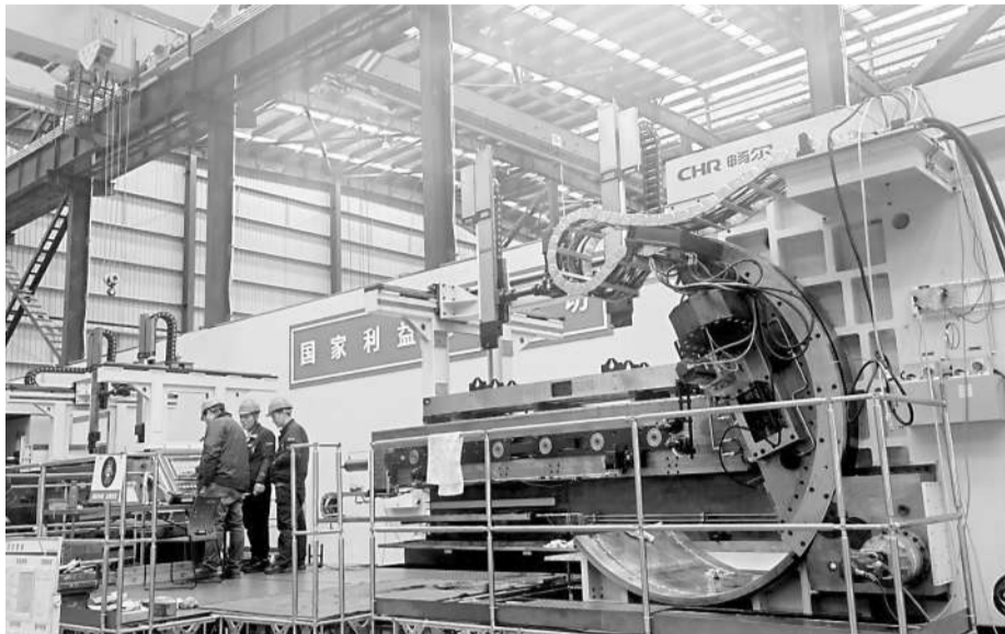
浙江畅尔智能装备股份有限公司工程师正在调试用于航空发动机机轮盘加工的高端拉床。该项目由浙江工业大学、杭州电子科技大学、上海大学、兰州理工大学与企业共同研发。 浙江省缙云县科技局供图
