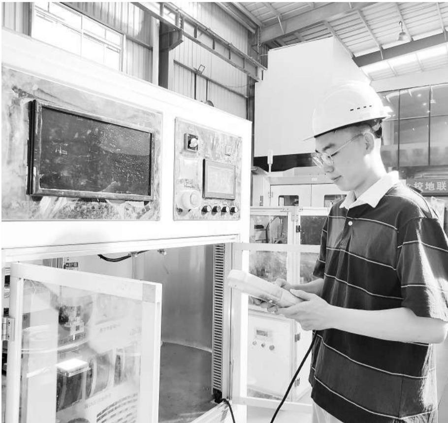
福建南安华大石材产业技术研究院研发人员在操作金刚石磨粒自动排布机,制备新型石材加工金刚石工具。受访者供图
