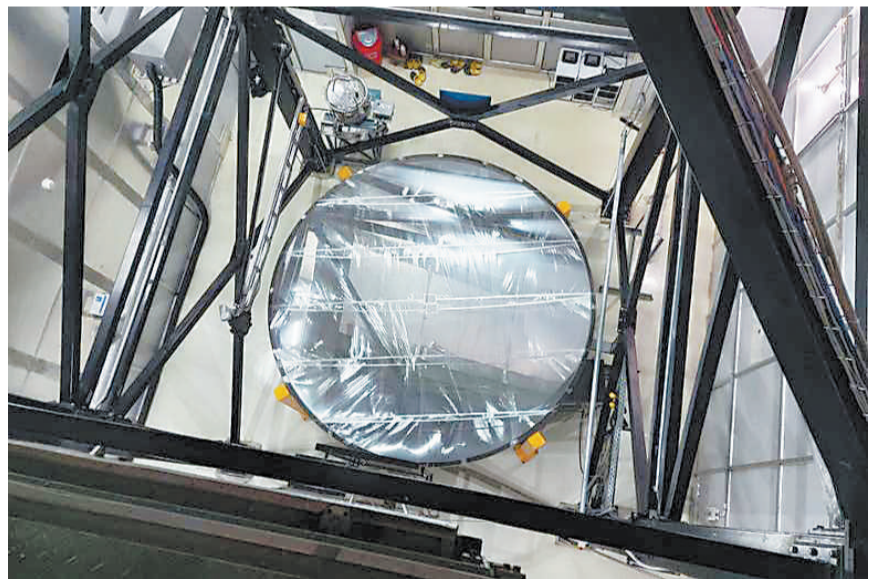
在液体镜面望远镜中，水银反射光线。
