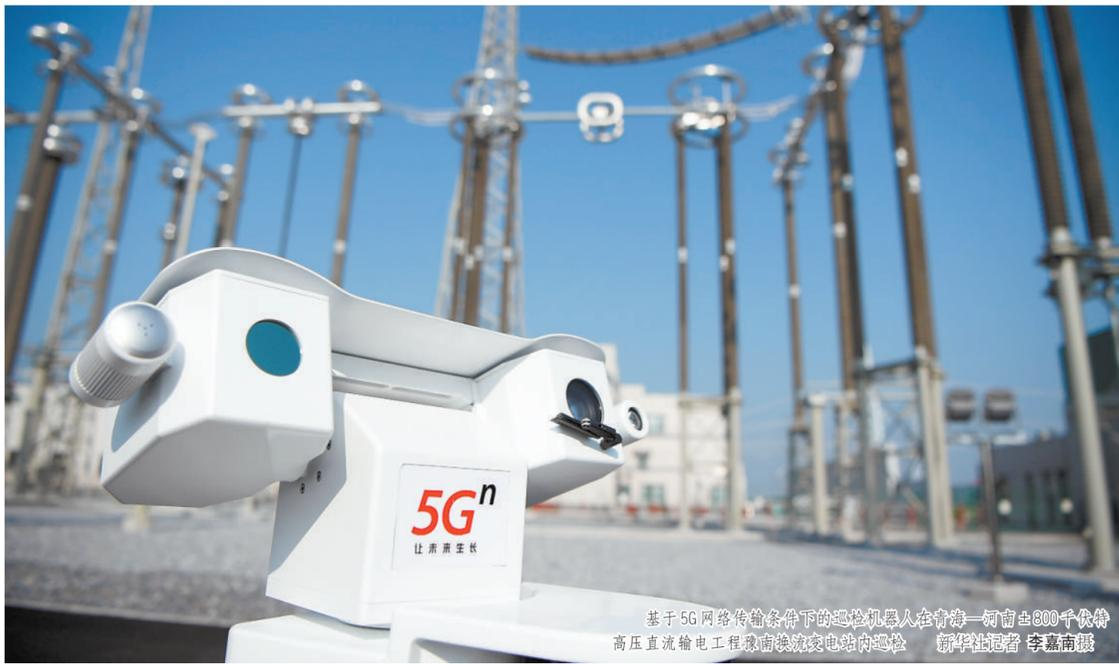
基于5G网络传输条件下的巡检机器人在青海—河南±800千伏特高压直流输电工程海南换流变电站内巡检 新华社记者 李嘉南摄
