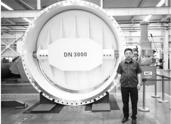
马玉山在数字化装配车间中，左侧为DN3000三偏心蝶阀（9月12日摄）。 新华社记者 杨植森摄
