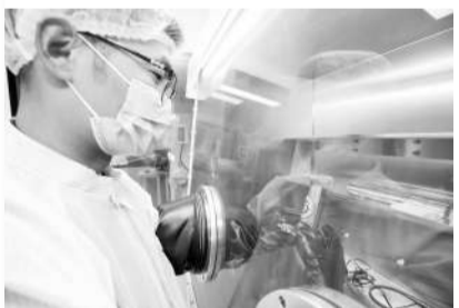
中国科学院地质与地球物理所的实验人员在手套箱里打开月壤样品 人民视觉供图
