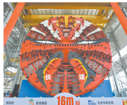
2020年9月27日,京华号盾构机在中国铁建重工集团长沙第一产业园下线。这台盾构机整机长150米,总重量4300吨,这是我国迄今研制的最大直径盾构机。新华社记者 戚晓毅摄
