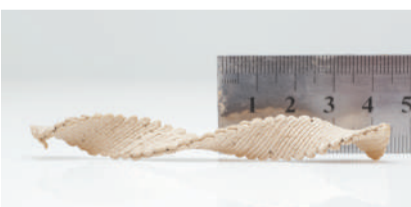
印刷成扁平矩形的墨水被编程为干燥固化后形成复杂的形状。
