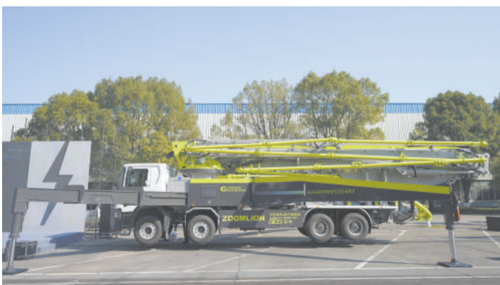
中联重科股份有限公司研制的行业首款国产化碳纤维臂架泵车 中联重科股份有限公司供图
