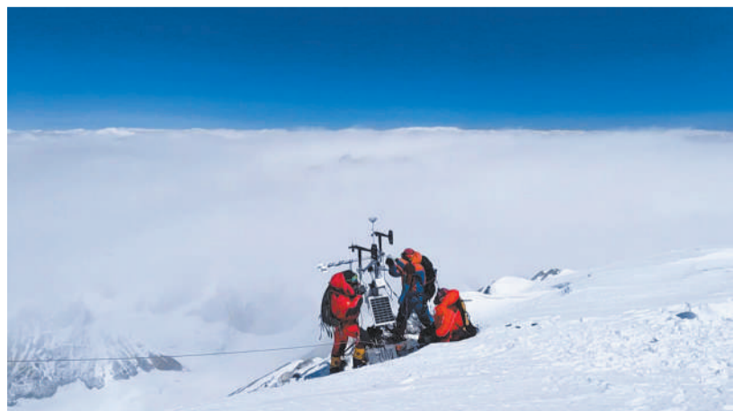
图为科考队员在海拔8830米处架设全球海拔最高的自动气象站。中央广播电视总台高山摄像组摄
