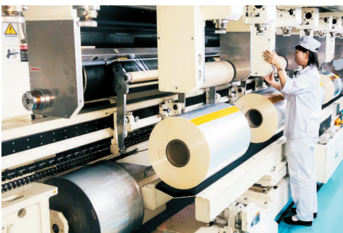
河北海伟集团电子材料有限公司的工人正在操作分切机分切电容薄膜 李冰摄
