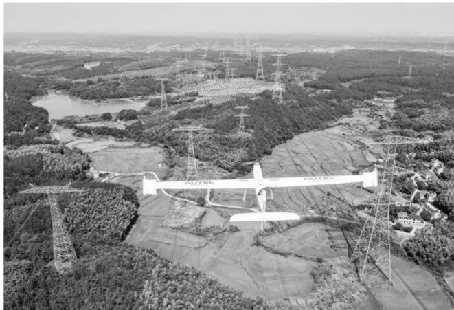
垂直起降固定翼机巢是部署在输电线路附近地面上的固定机巢,内部搭载一无人机,机巢可自动收放无人机、更换电池、自主巡航周边环境等,从而实现重要输电通道无人值守的全自动智能巡检作业。在安徽省电网智能巡检管控中心,工作人员下达起飞指令,垂直起降固定翼无人巡检机就可以从远在200多公里外的无人机机巢起飞,执行对宣城宣广特高压直流输电线路的自主巡检任务。图为6月15日,在安徽省宣城市宣州区,一架固定翼无人机在自主巡检重要输电通道(无人机照片)。
