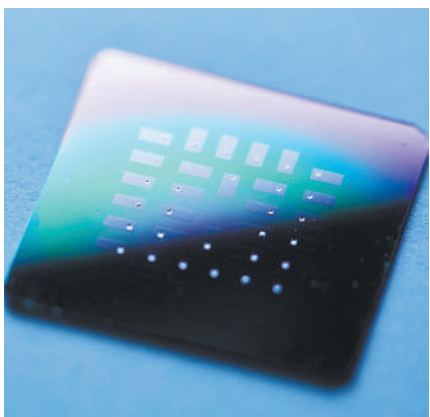
带有30个独立葡萄糖微型燃料电池的硅芯片。 图片来源:《先进材料》
