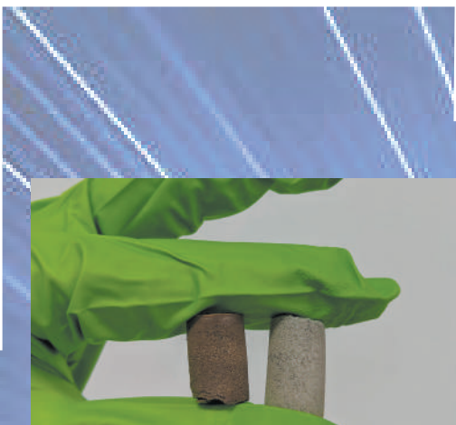
“火星土壤”材料比混凝土更坚固,由人类的血液、汗水、眼泪和尿液制成。 图片来源:英国曼彻斯特大学
