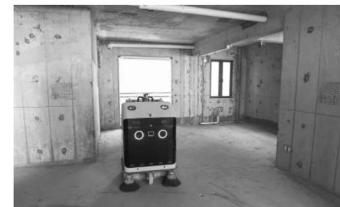
佛山顺德凤桐花园是住房和城乡建设部智能建造试点项目之一，多款建筑机器人在此落地并批量应用。图为近日在广东佛山顺德的在建住宅项目凤桐花园，一台配备了激光雷达、超声波传感器、防撞条等多传感器融合技术的楼层清洁机器人在施工现场清扫地面砂石尘土。
